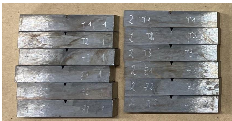
Slika 11: Vzorci za merjenje udarne žilavosti
